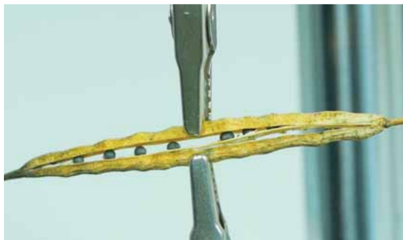
Síla potřebná pro puknutí odlučovací vrstvy obou chlopní šesule je rozdílná, prokázána je diference na úrovni 1,5 N. Nepukavé šesule udrží téměř 300g zátěž, zatímco pukavé zhruba polovinu
